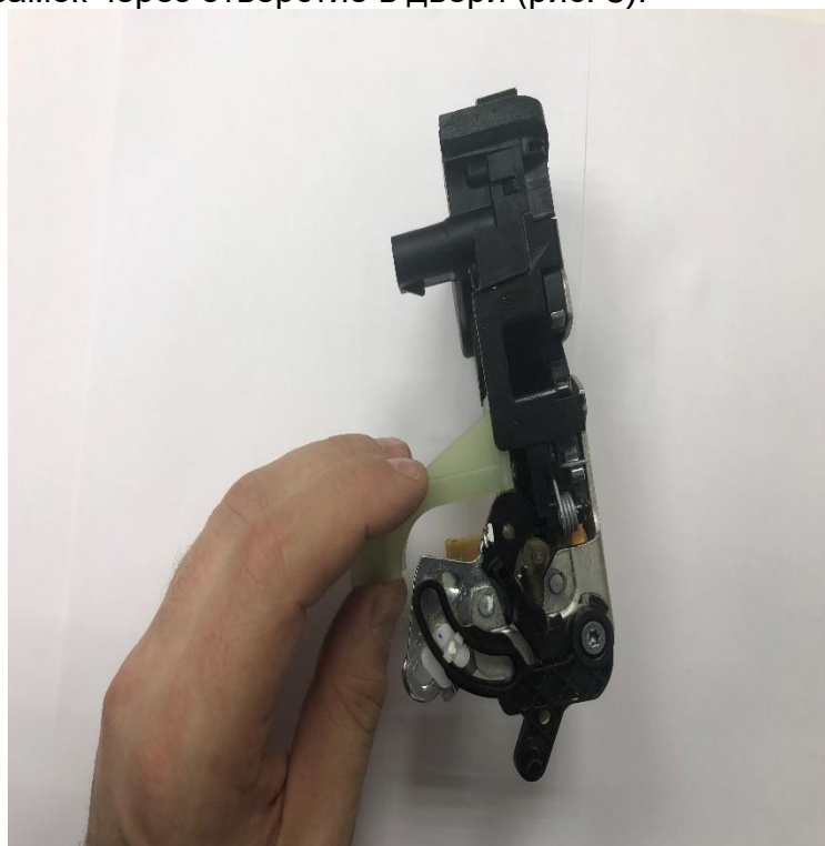
Рисунок 3 – Демонтаж штатного замка
