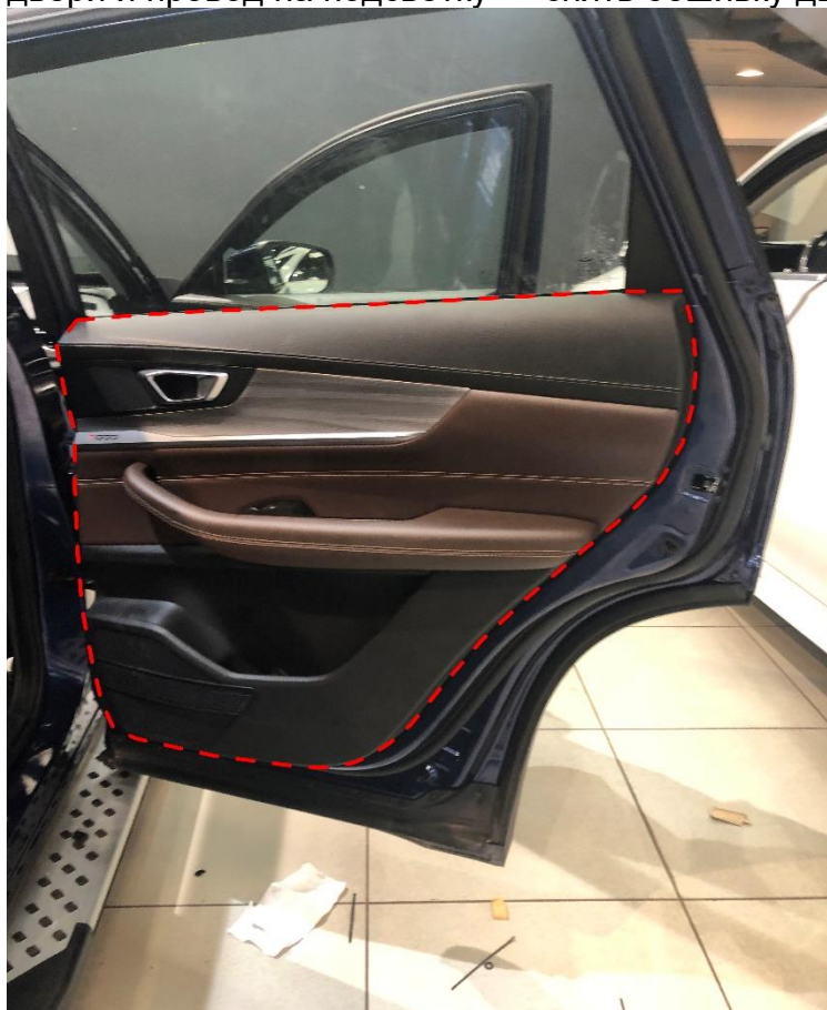
Рисунок 2 – Демонтаж обшивки двери
