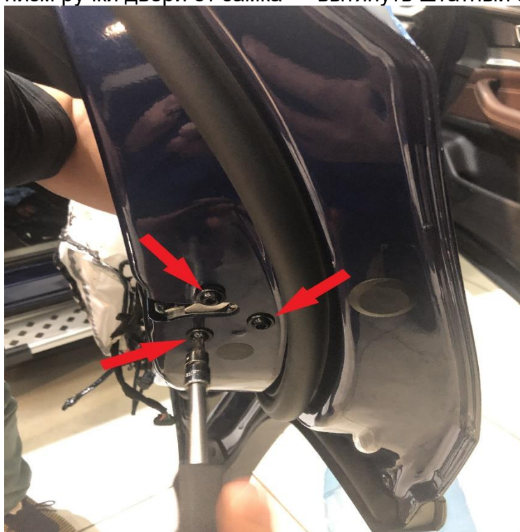
Рисунок 3 – Демонтаж штатного замка
