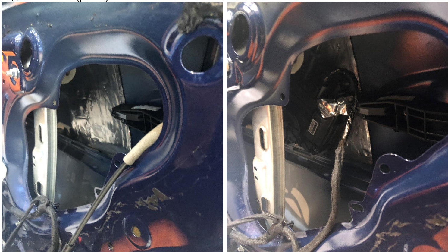
Рисунок 9 – Установка электропривода доводчика
