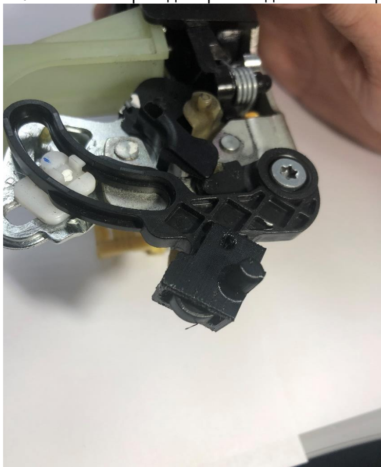
Рисунок 5 – Установка переходника детской блокировки
