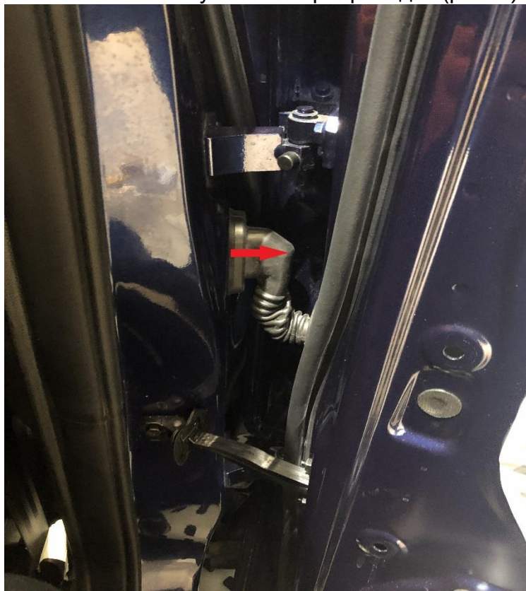
Рисунок 8 – Подключение питания к доводчику
