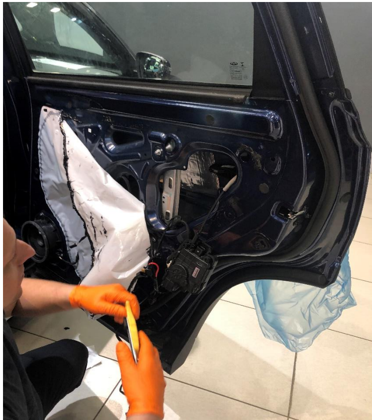
Рисунок 8 – Подключение питания к доводчику
