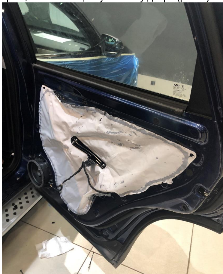
Рисунок 2 – Демонтаж обшивки двери
